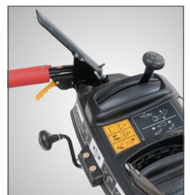
UTKAST-STYRNING FRÅN MANÖVERPANELEN
